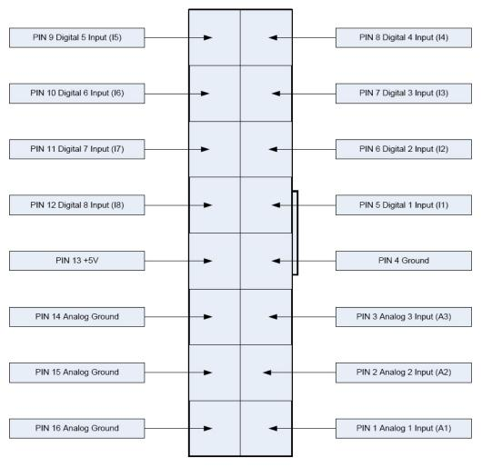
Figure 9.0 WebControl<sup>TM</sup> J12 Input pins
